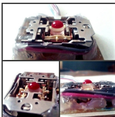
Рис.1. Лабораторный макет системы сдвиговых деформаций
